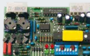
Indukciós hurok-kiértékelő Felpattintható 1- vagy 2-csatornás panel, alkalmas két különálló indukciós hurokhoz, szállítás hurokkábel nélkül
