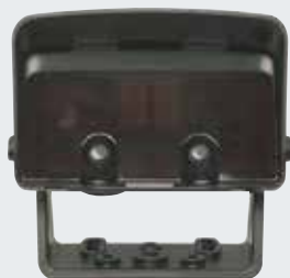
MWD radaros mozgásérzékelő Gyors és célzott automatikus kapunyitás, irányfelismerés, max. szerelési magasság 7 m, mélyhűtött térbe is szerelhető, -22°C-ig, Ház védettsége: IP 65
