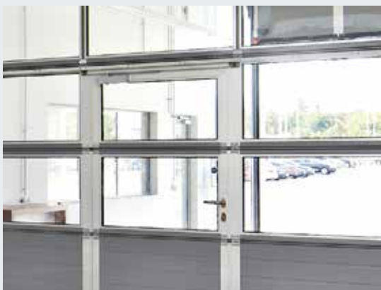
A színes kapuk belső oldalán a kapulap-merovítések** és a kapuelemek végelemeit RAL 9002, törtfehér színben szállítjuk. Személybejáró-ajtós kapuknál a személybejáró kerete a belső oldalon E6 / C0 eloxálású alumíniumprofilokból áll.
