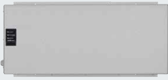
USV szünetmentes táp a feszültség-kimaradások legfeljebb 4 órás áthidalásához, biztonsági berendezések, jelzőlámpák stb. működőképesek maradnak; LED-es állapotkijelzés, automatikus akkumulátorteszt, túlfeszültség-védelem Méretek: 560 x 235 x 260 mm (Sz x Ma x Mé) Védettség: IP 20
