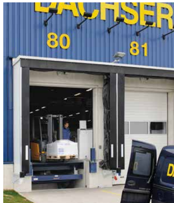
A liftes szintkiegyenlítő valójában egy előtolónyelves rámpakiegyenlítő és egy ollós emelőasztal kombinációja
