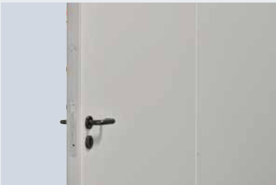
Teljes felületen ragasztott héjazatú, csap-hornyos módon egymásba kapcsolódó, 72 mm vastag kapulapi elemek
